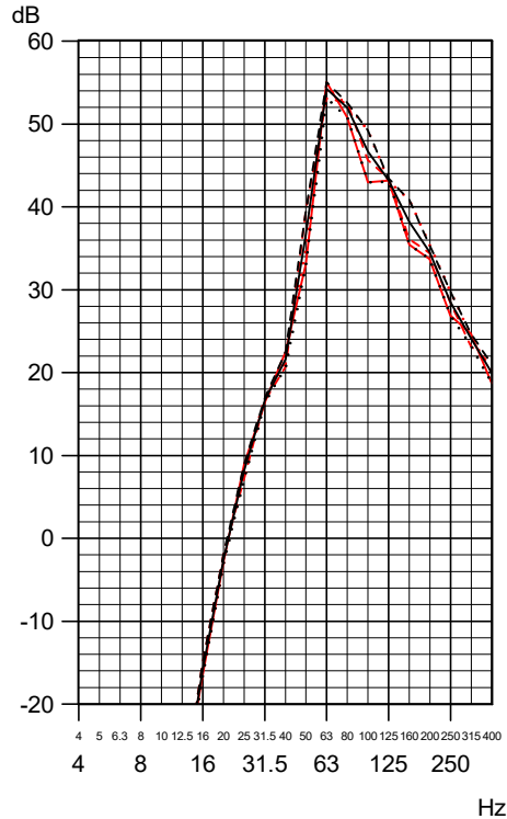
Messpunkt 01G; vertikal Freifeld; zwischen Haus 5 und Bahnlinie prog. sek. Luftschall [FAST, A-bew.]
