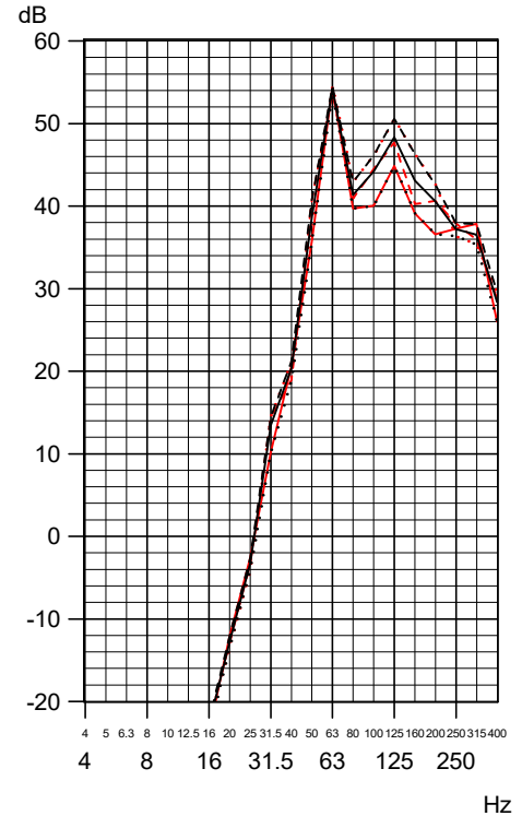
Messpunkt 02G; vertikal Freifeld; zwischen Haus 4 und Bahnlinie prog. sek. Luftschall [FAST, A-bew.]
