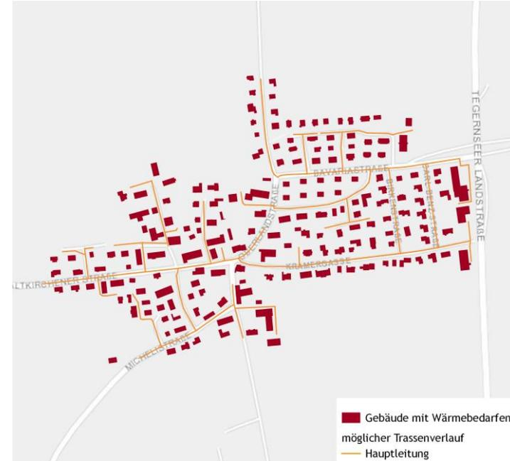
Berechnetes Wärmenetz in Lochhofen (eigene Darstellung INEV)
