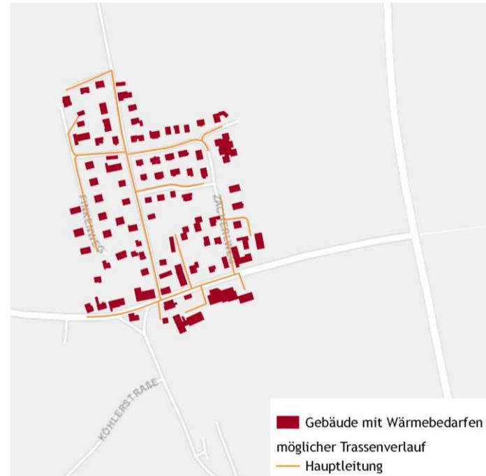
Berechnetes Wärmenetz in Arget Nord (eigene Darstellung INEV)
