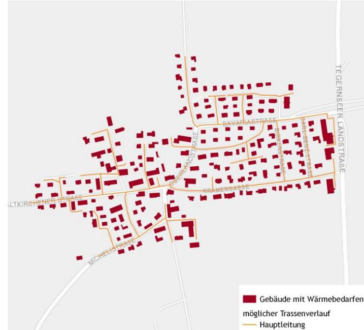
Berechnetes Wärmenetz in Lochhofen (eigene Darstellung INEV)
